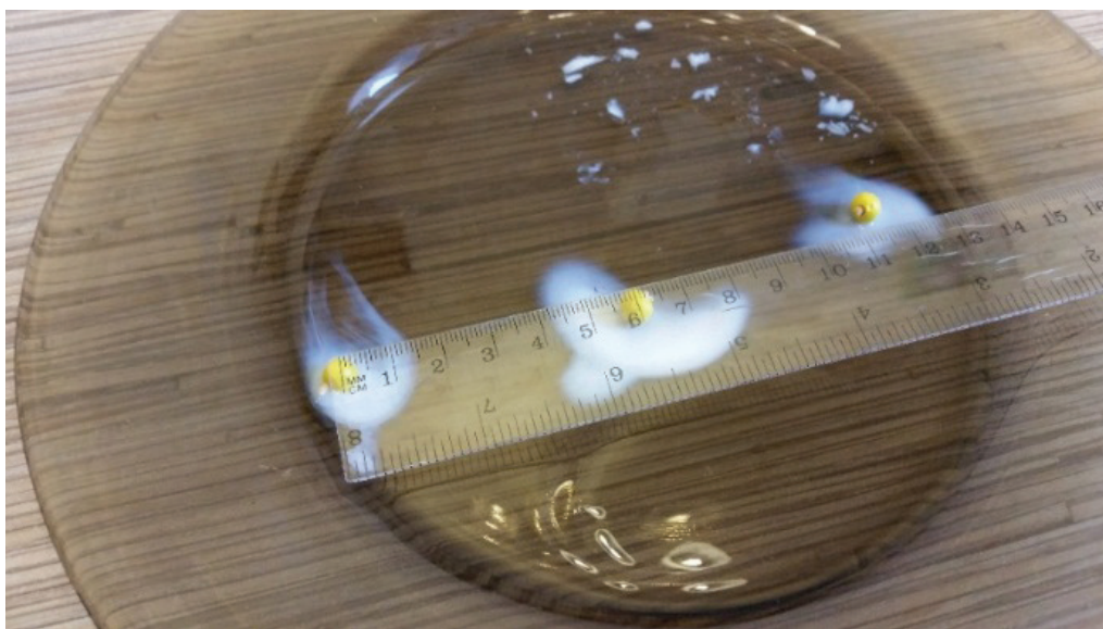
Рис. 2. Проведение измерений расстояния между пиками «стоячей волны»
